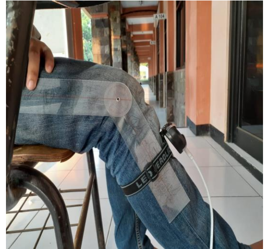
Gambar 10. Pemasangan goniometer manual dan goniometer pintar
