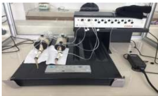
Gambar 1. Pengecekan tekanan darah dengan menggunakan alat instrument NIBP ( Non invasive blood pressure ) merk CODA (kent scientific).
