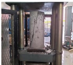
Gambar 4. Pengujian Kuat Tekan Beton
