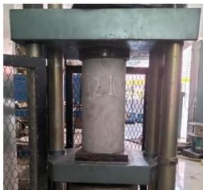
Gambar 2. Pengujian Kuat Tekan Beton
