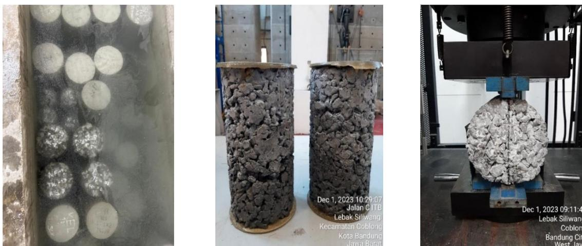
**Gambar 4** Dokumentasi perawatan dan pengujian beton porous
